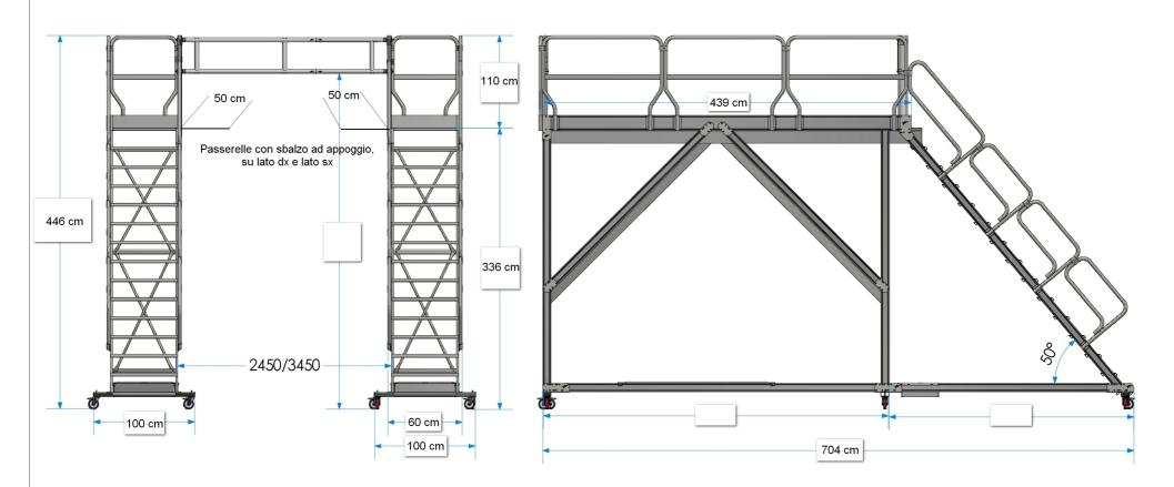
Deve essere provvista di: ruote piroettanti, base con stabilizzatori, e cancello con apertura verso l'esterno sull'ingresso delle due scale di salita
