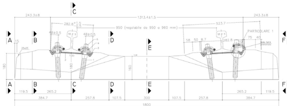
Figura 3: Traversa monoblocco in CAP tipo SR 180V (sezione longitudinale)
