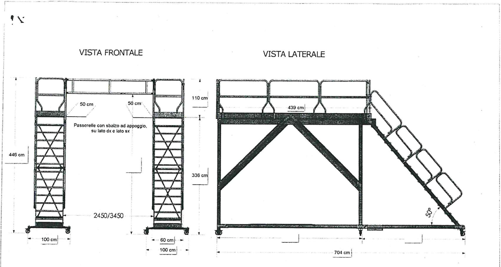
Deve essere provvista di: ruote piroettanti, base con stabilizzatori, e cancello con apertura verso l'esterno sull'ingresso delle due scale di salita
